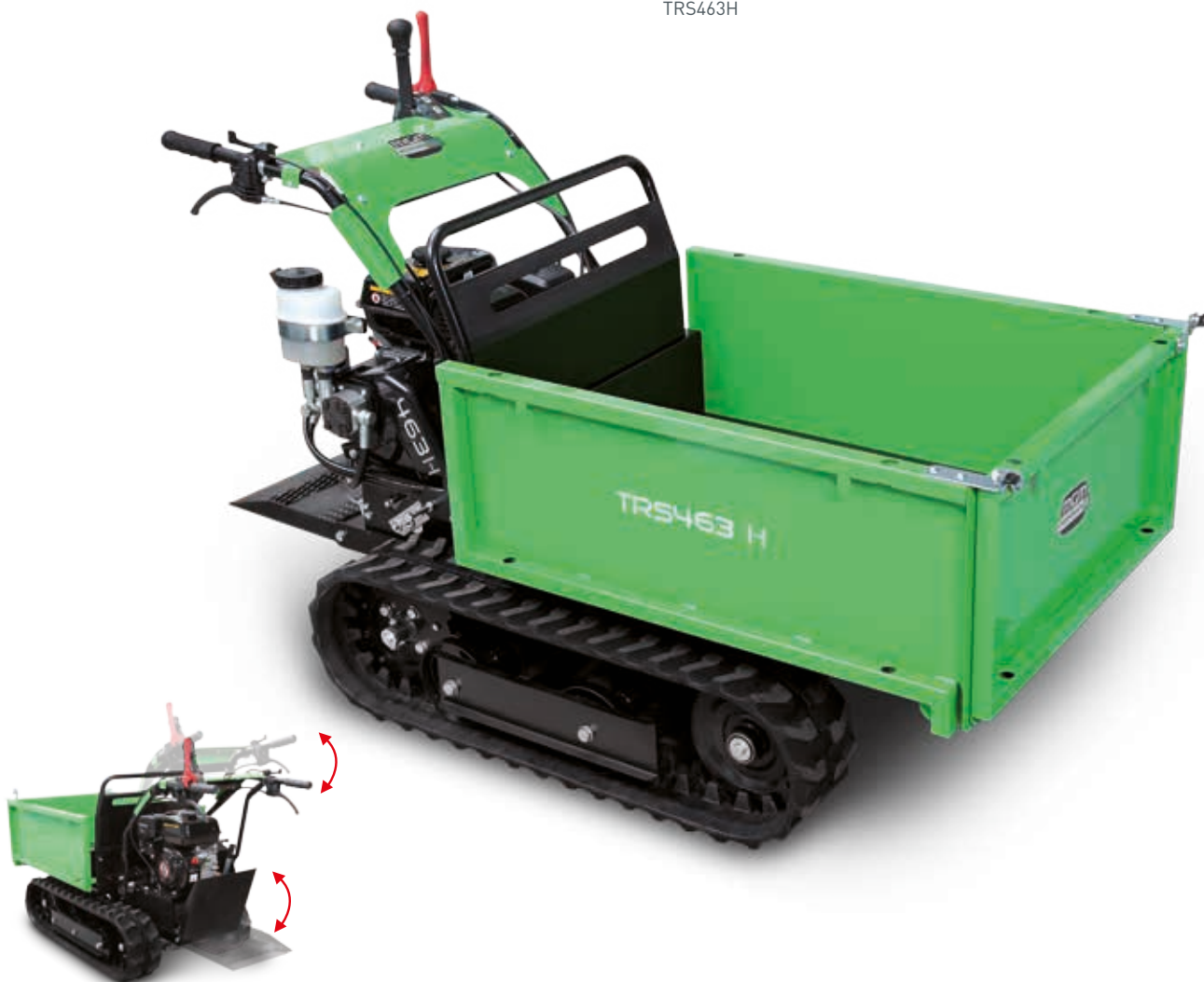
Stegola orientabile in altezza dotata di sincronismo apertura e chiusura pedana High adjustable handlebars synchronized with operator platform
