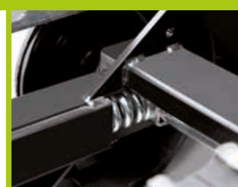
Tenditore cingolo a molla autoregolante Self-adjusting spring tensioner
