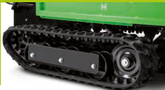
Carro rinforzato con rulli montati su doppio cuscinetto Reinforced chassis Rollers with double sealed bearings
