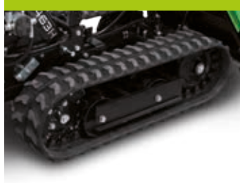
Carro TRS463 con doppia ruota alta Rulli con cuscinetto doppia tenuta stagna Chassis TRS463 with hight double wheel. Rollers with double sealed bearings
